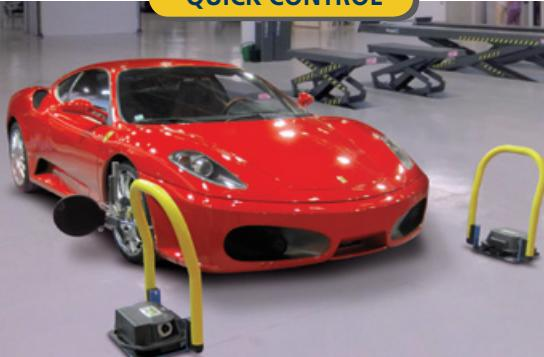
QC2R (Contrôle Radipe Reverse 2 Têtes) permet le contrôle rapide des angles directs: parallélisme total et carrossage
