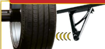
Dopo aver abbassato il carter il sonar rileva automaticamente le misure della ruota
