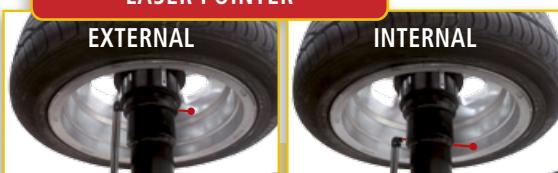
Il puntatore laser indica la posizione esatta dove incollare i pesi
